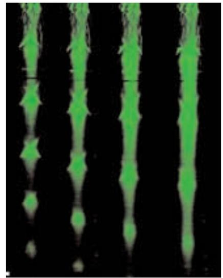
**Figura 6.** Ondas de choque en un jet supersónico. **a)** Muestra el primer cruce entre una onda de expansión y una de compresión. **b)** Muestra una serie de cruzamientos para cuatro chorros diferentes. (Fotografías tomadas por C. Aguilar Espinosa y C. Azpeitia Sandoval, en el laboratorio de Acústica de la Facultad de Ciencias de la UNAM).
