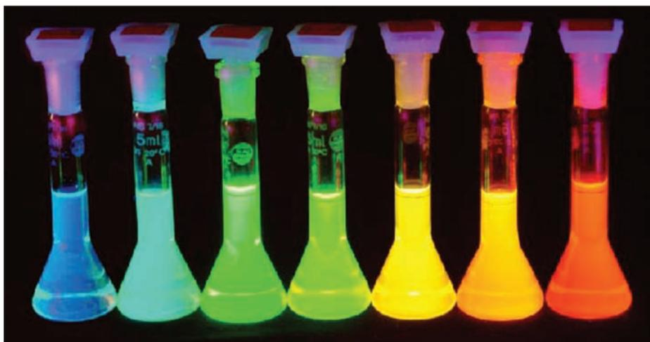
**Figura 1.** Con tan sólo variar su tamaño, las nanopartículas semiconductoras, o puntos cuánticos, pueden tener distintos colores. El color rojo corresponde a puntos cuánticos de seleniuro de cadmio (CdSe) de aproximadamente 7.5 nanómetros (millonésimas de milímetro), mientras que el azul corresponde a nanopartículas de aproximadamente 2 nanómetros.
