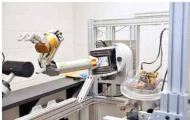
**Figura 4.** Mono Rhesus controlando un brazo robótico directamente con sus registros corticales para cumplir una tarea de posicionamiento. Imagen tomada de: <<http://spectrum.ieee.org/automaton/robotics/medical-robots/060210-monkey-controls-advanced-robot-using-its-mind>>.
