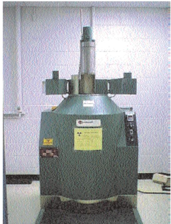
**Figura. 2.** Sistema de un irradiador gamma de cobalto-60, también llamado "gammacell".
