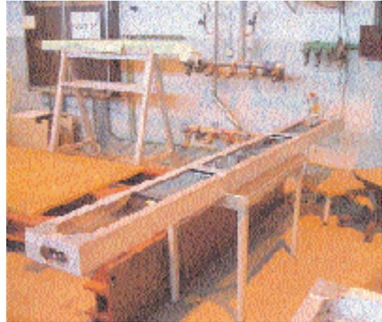
**Figura 9.** En la parte superior del magneto de ALICE se colocarán 120 paneles como el que se muestra aquí. Estos módulos están siendo fabricados y probados en México y serán trasladados al CERN a finales de 2004. Cada uno de estos contadores tiene 20 centímetros de ancho y una longitud sensible de 1.9 metros. El diseño es resultado de estudios de simulación hechos por el grupo mexicano y ha sido aprobado por la colaboración para entrar en la fase de producción.
