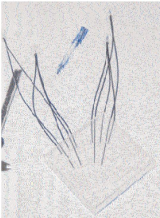
**Figura 8.** Prototipo de una sección del detector V0A. En este diseño las celdas son grabadas en una sola pieza de plástico que mantiene su rigidez mecánica. Las celdas se aíslan con resina después de hacer canales por ambos lados del plástico. Las fibras ópticas están embebidas en el plástico para lograr una mejor recolección de luz.
