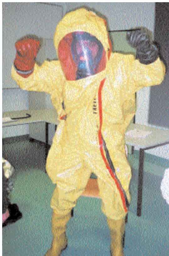
Traje de protección total que consiste en una cápsula de una sola pieza. Pesa unos 14 kg y requiere de respirador autónomo con tanque de aire.
