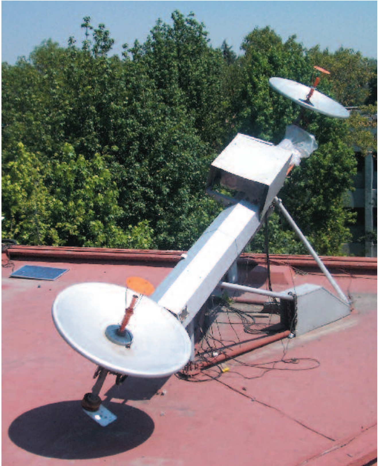
Figura 1. El radiointerferómetro solar de base pequeña (RIS). Actualmente está instalado en el Instituto de Geofísica de la UNAM.
