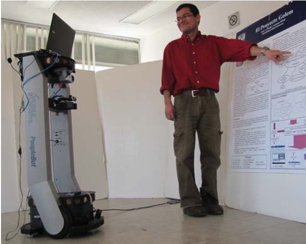
Figura 3. Robot Golem-II+, capaz de guiar una sesión de carteles en español hablado e interpretar gestos (como señalar, por ejemplo) expresados por el interlocutor humano.
