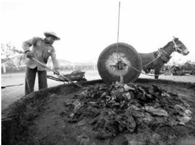
Figura 4. Molienda y extracción del jugo de las piñas del maguey.
