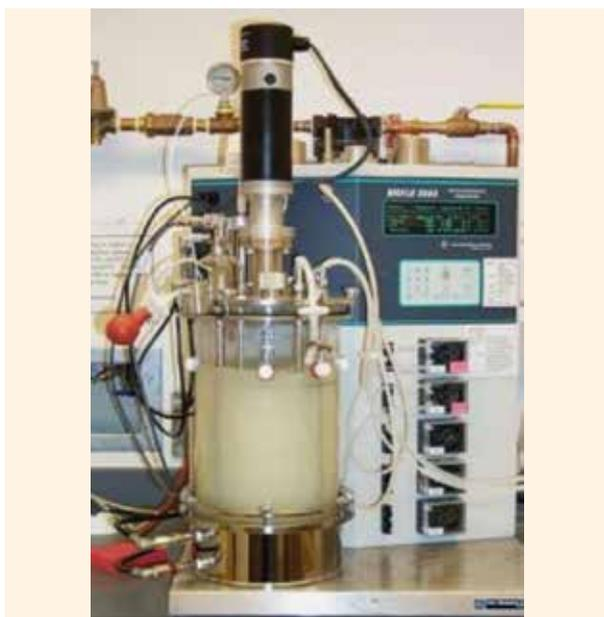
**Figura 2.** Cultivo en fermentador de 1.5 litros para la producción de L-tirosina por *Escherichia coli*, modificada mediante ingeniería metabólica.
