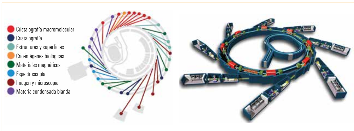
Figura 2. Esquemas de las líneas experimentales: (izquierda) del sincrotrón del Reino Unido, Diamond, con sus usos principales y (derecha) estructura genérica de las líneas.
