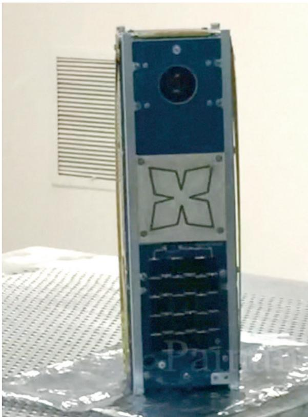
Figura 4. Antena de un CubeSat.
