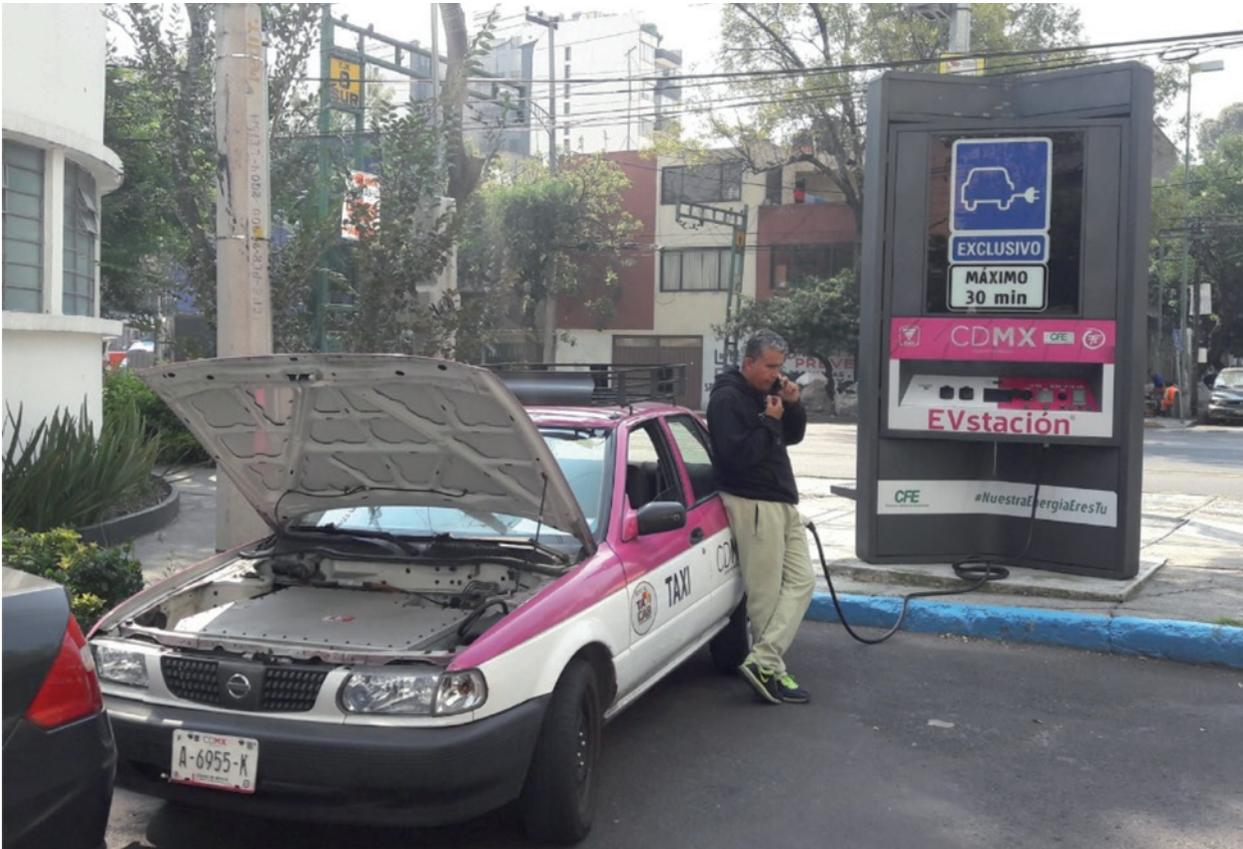
**Figura 2.** Taxi convertido a tracción eléctrica, con 250 km de autonomía y más de 100 000 km recorridos en la Ciudad de México.
