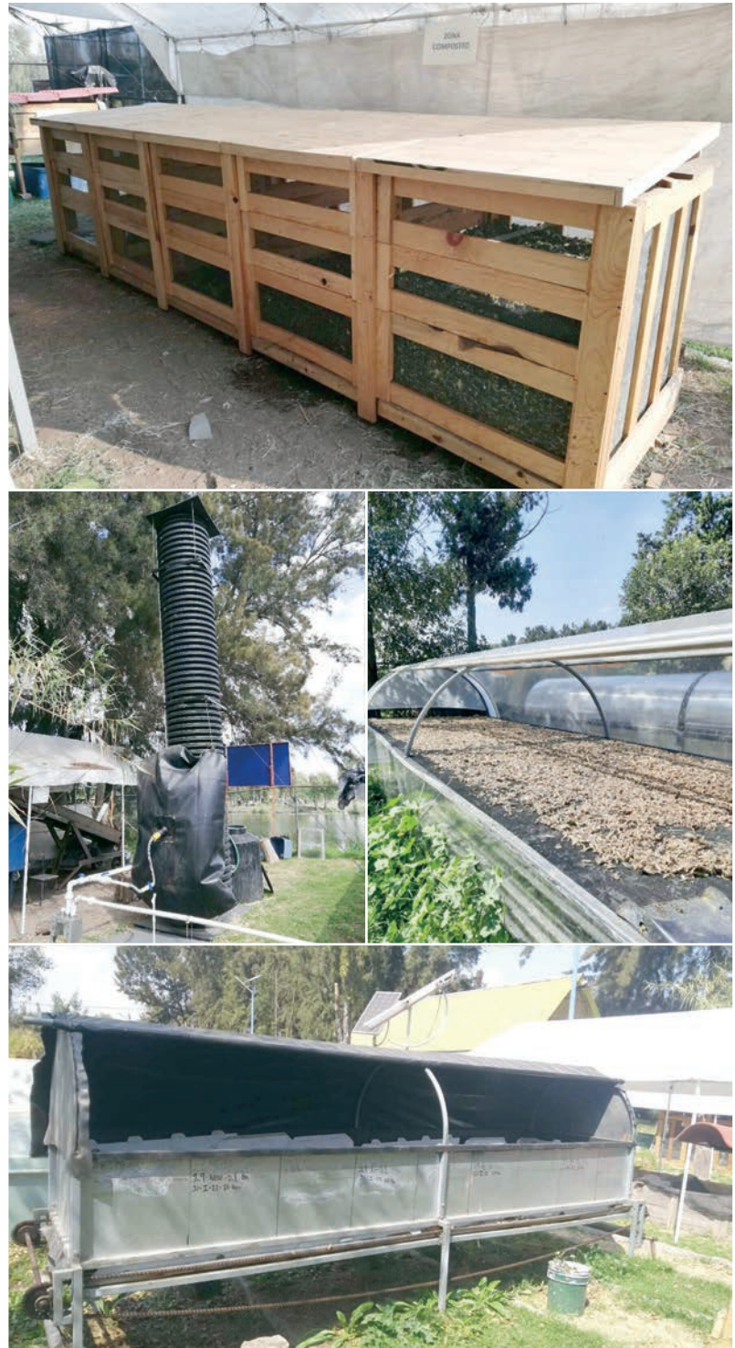
Figura 5. Equipos utilizados en la Biorrefinería LirMex III para producir composta, lombricomposta, material absorbente y biogás. Crédito: Biorrefinería LirMex III.
