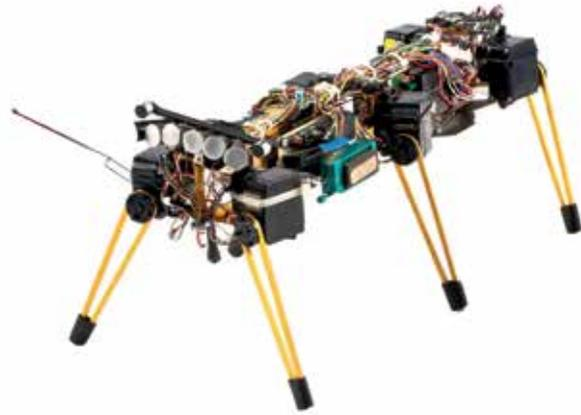
**Figura 4.** Robot Genghis del MIT. Crédito: [www.robotsguide.com](http://www.robotsguide.com).
