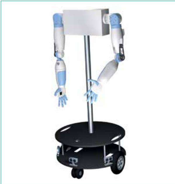
**Figura 2.** Xolobot: robot con brazos antropomorfos controlado con la arquitectura cognitiva cerebral, inspirada en el sistema nervioso central.
