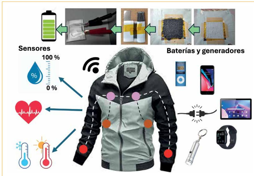
**Figura 5.** Algunas aplicaciones de textiles inteligentes en dispositivos de almacenamiento y generación de energía eléctrica, así como en el monitoreo de signos vitales y condiciones ambientales.
