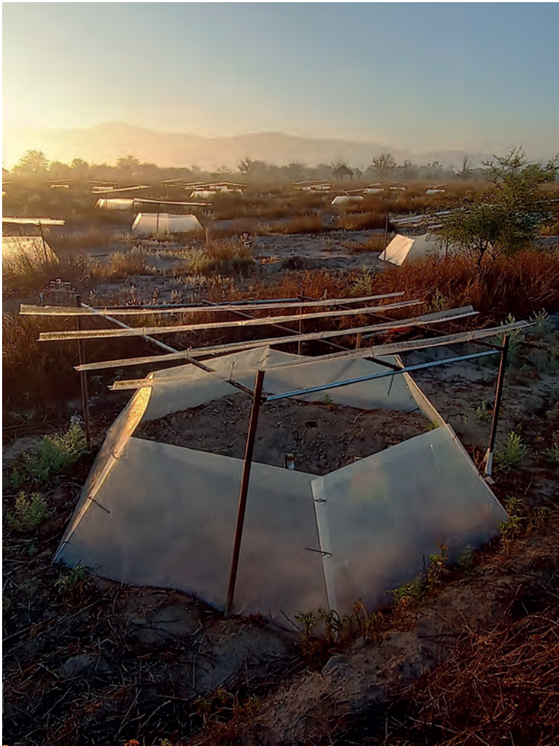
Figura 2. Fotografía de un experimento de campo realizado con cámaras de techo abierto y refugios de lluvia para simular las condiciones de cambio climático que se esperan en México.
